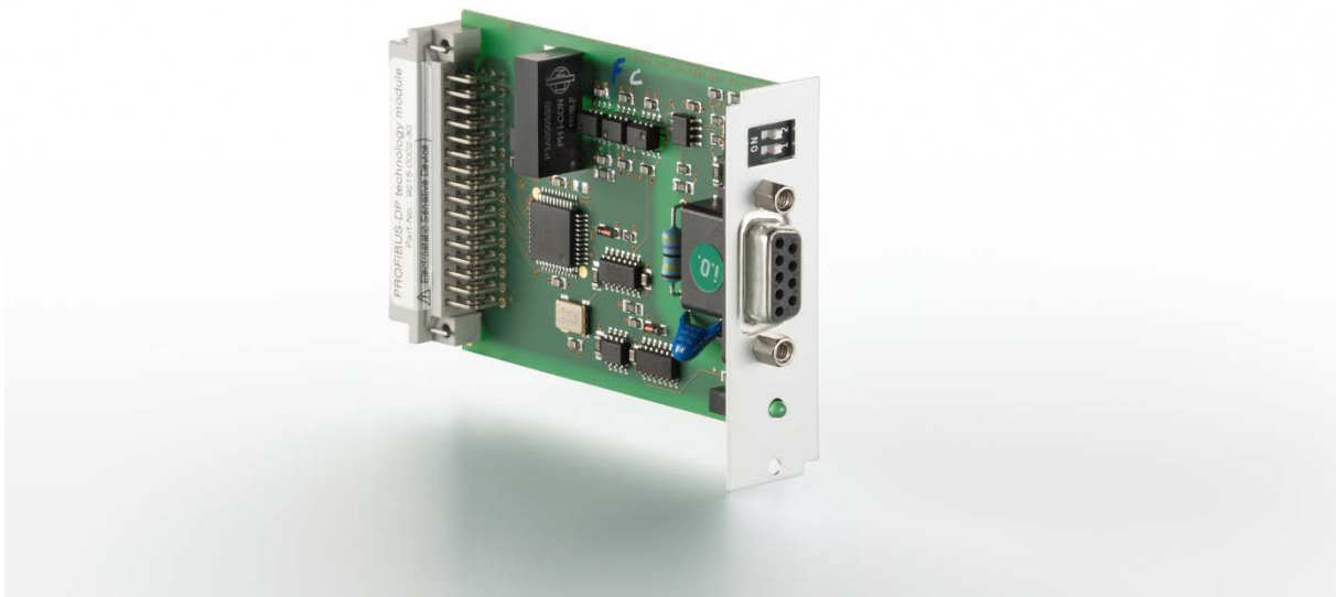
Abbildung 27: PROFIBUS-DP-Interface: Ansicht vorne
