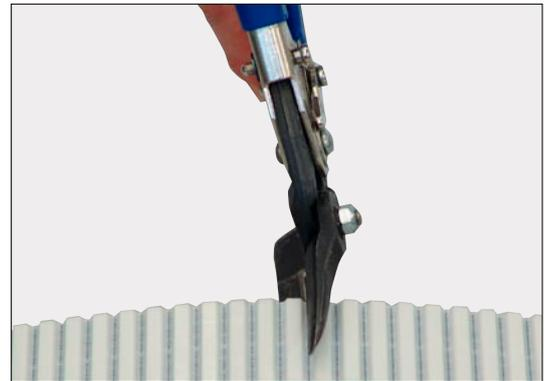
Der zugeschnittene Zahnriemen wird über dem Stahlband in den Profilgrund eingeschoben, so dass er zu beiden Seiten übersteht.
