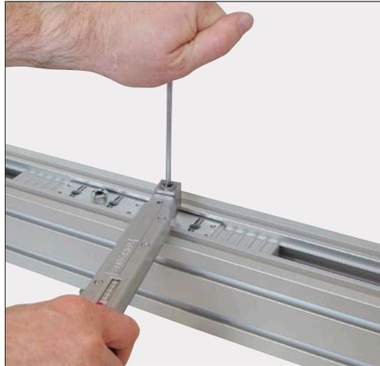
Der Schlitten wird wieder aus der Führungsbahn genommen und die Federn und Filze des Abstreif- und Schmierystems in die dafür vorgesehenen Positionen am Schlitten montiert.
