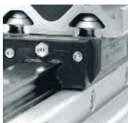
Die obere Anschlussfläche des Führungswagens ist so ausgeführt, dass ein Profil der Baureihe 8 montiert werden kann. Selbstverständlich kann jedoch die Schlittenkonstruktion auch in anderer Form ausgeführt werden. Auflagefläche sind in diesem Fall dann ausschließlich die Mittelrippen der Wagenrückseite. Die Befestigung von Profilen 8 auf den Kugelumlauf-Wagen kann mit Halbrundschaublen ISO 7380 und Nutscheiben 8 erfolgen.
