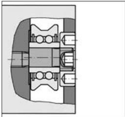
Die exzentrischen Lagereinheiten müssen vor dem Einsetzen des Führungswagens bezüglich ihrer Exzenterlage vorbereitet werden.
