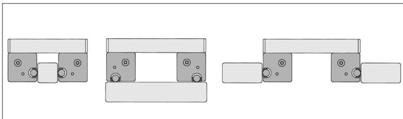
Die Laufrollenprofile bieten variable Befestigungsmöglichkeiten über Nuten der Baureihe 5, wodurch sich die Montage und das Ausrichten auf Profilen oder Aufspannplatten wesentlich vereinfacht.
