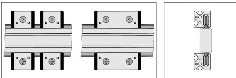
Zum Aufbau einer Linearführung werden grundsätzlich zwei zentrische (feste) und gegenüber zwei exzentrische (einstellbare) Lagereinheiten benötigt. Zwei einzelne Lagereinheiten können auch durch je eine Doppellagereinheit ersetzt werden. Bei Bedarf können auch entsprechend mehr Lagereinheiten eingesetzt werden.
