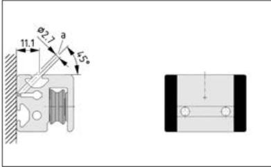
Bei undefinierten Belastungen der Führungseinheit, wie z. B. Schlagbelastungen, die zu einer Verschiebung der Lagereinheiten führen können, müssen die Lagereinheiten gesichert werden. Dies kann an den angegebenen Positionen bzw. dunkelgrau gekennzeichneten Bereichen durch Aufbohren und Verstiften (a) erfolgen.
