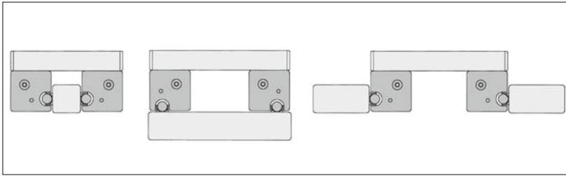
Die Laufrollenprofile bieten variable Befestigungsmöglichkeiten über Nuten der Baureihe 5, wodurch sich die Montage und das Ausrichten auf Profilen oder Aufspannplatten wesentlich vereinfacht.
