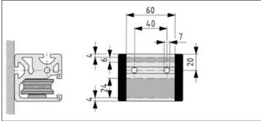
Die exzentrischen Lagereinheiten müssen vor dem Einsetzen des Führungswagens bezüglich ihrer Exzenterlage vorbereitet werden.
