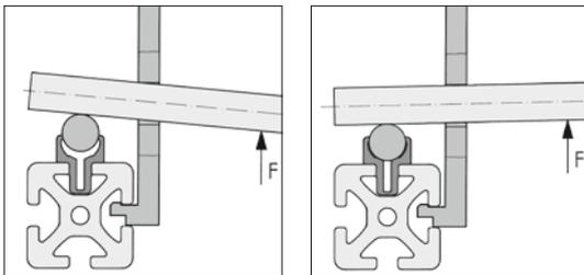
Bei längeren Strecken, deren Trägerprofile bereits montiert sind oder z. B. im Schraubstock gehalten werden, kann nach dem Eindrücken des Wellenklemmprofils die Welle unter Zuhilfenahme des Montagewinkels (Best.-Nr. 0.0.265.38) und eines entsprechenden Rundstahls als Hebel abschnittsweise in das Wellenklemmprofil eingepresst werden.
