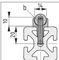
Bei höheren Belastungen empfiehlt sich ein Festsetzen der Welle. Die Bearbeitung von Welle, Wellenklemmprofil und Trägerprofil erfolgt vorzugsweise mittels Kombi-Bohrlehre (c) in folgenden Schritten:
