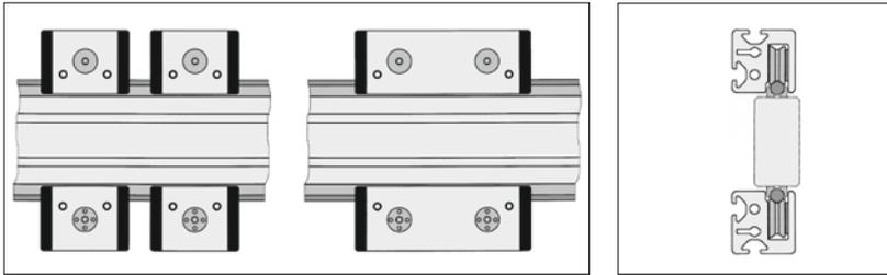
Zum Aufbau einer Linearführung werden grundsätzlich zwei zentrische (feste) und gegenüber zwei exzentrische (einstellbare) Lagereinheiten benötigt. Zwei einzelne Lagereinheiten können auch durch je eine Doppellagereinheit ersetzt werden. Bei Bedarf können auch entsprechend mehr Lagereinheiten eingesetzt werden.
