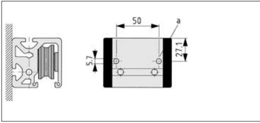
Bei undefinierten Belastungen der Führungseinheit, wie z. B. Schlagbelastungen, die zu einer Verschiebung der Lagereinheiten führen können, müssen die Lagereinheiten gesichert werden. Dies kann an den angegebenen Positionen bzw. dunkelgrau gekennzeichneten Bereichen durch Aufbohren und Verstiften (a) erfolgen.
