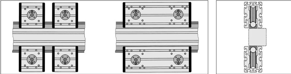
Zum Aufbau einer Linearführung werden grundsätzlich zwei zentrische (feste) und gegenüber zwei exzentrische (einstellbare) Lagereinheiten benötigt. Zwei einzelne Lagereinheiten können auch durch je eine Doppellagereinheit ersetzt werden. Bei Bedarf können auch entsprechend mehr Lagereinheiten eingesetzt werden.
