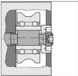
Die exzentrischen Lagereinheiten müssen vor dem Einsetzen des Führungswagens bezüglich ihrer Exzenterlage vorbereitet werden. Der Innensechskantschlüssel dreht dabei den exzentrischen Bolzen der Laufrollen:
