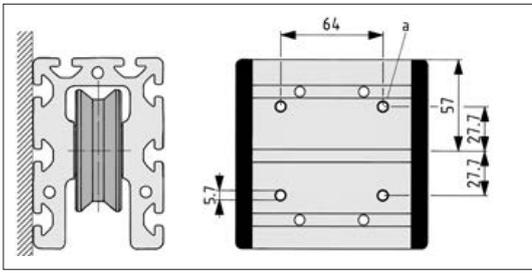
Bei undefinierten Belastungen der Führungseinheit, wie z. B. Schlagbelastungen, die zu einer Verschiebung der Lagereinheiten führen können, müssen die Lagereinheiten gesichert werden. Dies kann an den angegebenen Positionen bzw. dunkelgrau gekennzeichneten Bereichen durch Aufbohren und Verstiften (a) erfolgen.
