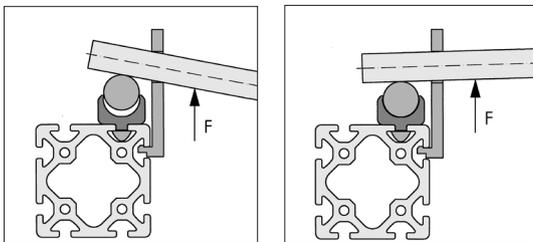
Bei längeren Strecken, deren Trägerprofile bereits montiert sind oder z. B. im Schraubstock gehalten werden, kann nach dem Eindrücken des Wellenklemmprofils die Welle unter Zuhilfenahme des Montagewinkels (Best.-Nr. 0.0.265.38) und eines entsprechenden Rundstahls als Hebel abschnittsweise in das Wellenklemmprofil eingepresst werden.
