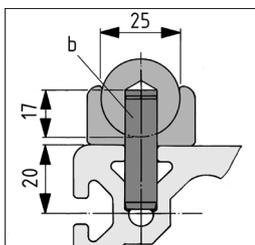
Bei höheren Belastungen empfiehlt sich ein Festsetzen der Welle. Die Bearbeitung von Welle, Wellenklemmprofil und Trägerprofil erfolgt vorzugsweise mittels Kombi-Bohrlehre (c) in folgenden Schritten:
