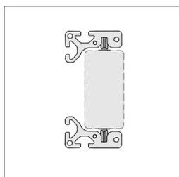
Zum Aufbau einer Linearführung werden grundsätzlich zwei zentrische (feste) und gegenüber zwei exzentrische (einstellbare) Lagereinheiten benötigt. Zwei einzelne Lagereinheiten können auch durch je eine Doppellagereinheit ersetzt werden. Bei Bedarf können auch entsprechend mehr Lagereinheiten eingesetzt werden.
