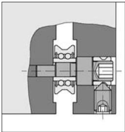
Die exzentrischen Lagereinheiten müssen vor dem Einsetzen des Führungswagens bezüglich ihrer Exzenterlage vorbereitet werden:
