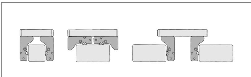
Die Laufrollenprofile bieten variable Befestigungsmöglichkeiten über Nuten der Baureihe 8, wodurch sich die Montage und das Ausrichten auf Profilen oder Aufspannplatten wesentlich vereinfacht.
