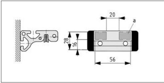
Bei undefinierten Belastungen der Führungseinheit, wie z. B. Schlagbelastungen, die zu einer Verschiebung der Lagereinheiten führen können, müssen die Lagereinheiten gesichert werden. Dies kann an den angegebenen Positionen bzw. dunkelgrau gekennzeichneten Bereichen durch Aufbohren und Verstiften (a) erfolgen.
