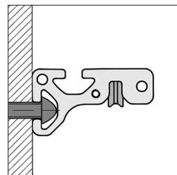
Bei längeren Strecken, deren Trägerprofile bereits montiert sind oder z. B. im Schraubstock gehalten werden, kann nach dem Eindringen des Wellenklemmprofils die Welle unter Zuhilfenahme des Montagewinkels (Best.-Nr. 0.0.265.38) und eines entsprechenden Rundstahls als Hebel abschnittsweise in das Wellenklemmprofil eingepresst werden.
