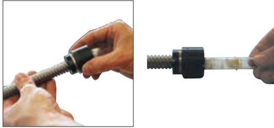
Sollte es, trotz vorsichtiger Montage, zu einem Kugelverlust kommen, so können einzelne Kugel wieder eingesetzt werden. Dazu wird die Flanschmutter vorsichtig an das freie Ende der Spindel gedreht, bis einzelne Kugeln sichtbar sind. Die losen Kugeln können nun zwischen vorhandene Kugeln in die Lastbahn (auf keinen Fall in die Rücklaufbahn) eingesetzt werden.
