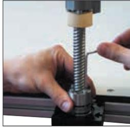
Die Spannringnabe der Loslagerseite ist zuerst zu montieren. Sollte der Lagersitz der Spannringnabe zu viel Übermaß aufweisen, ist es sinnvoll, die Spannringnabe so anzupassen, dass sie mit leichten Hammerschlägen gefügt werden kann. Dies geschieht am besten durch drehende Aufnahme und die Verwendung von Schmirgelpapier.
