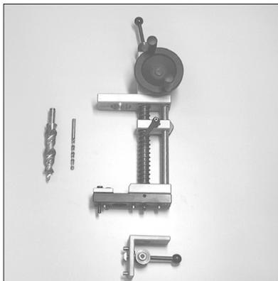
Der Bohrständer wird über eine Klemm-Befestigung mit dem Profil verbunden.
