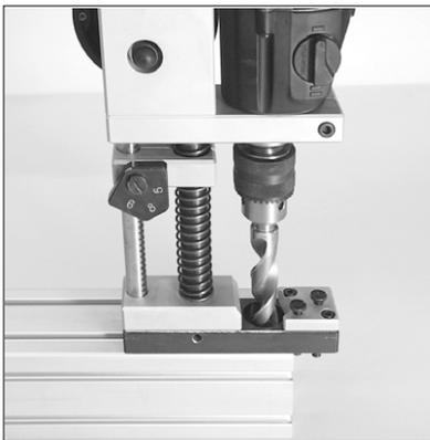
Die Bohreinheit wird auf dem Profil in die Bohrposition verschoben (Anschlag I) und dort mit dem Klemmhebel befestigt. Beim Bohren begrenzt nun der Anschlag die Bohrtiefe für die Universalverbinder-Senkung.
