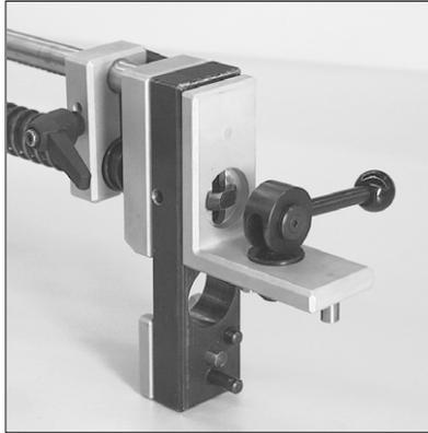
Anschließend wird die Bohreinheit mit dem Befestigungswinkel an das zu bearbeitende Profil gespannt und die Bohrung ausgeführt.
