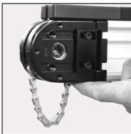
Die beiden Endglieder der Kette werden aus der Kettenführung an der vorbereiteten Stelle herausgehoben und mit den Kettenschloss verbunden.
