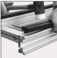
Die Gleitleiste ist im Abstand von 20 mm von der Profilkante zu positionieren, so dass die Kette über die Auflaufkeile wie dargestellt in die Kettenumlenkung eingeführt wird. Die Auflaufkeile müssen in der Profilvernut verschraubt werden.
