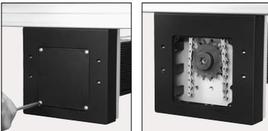
Die Kette ist innerhalb der Gegenumlenkung durch Abnehmen der Kunststoff-Abdeckkappen zugänglich. Es wird empfohlen, das Kettenschloss durch diese Wartungsöffnung innerhalb der Kettengegenumlenkung zu montieren.
