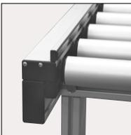
Die Gehäuseprofile sind zum Schutz gegen Berührung der Kettenräder an ihren Stirnseiten mit den Abdeckkappen zu verschließen.
