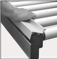
Die Ausführung des Gehäuseprofils mit Bordkante ermöglicht die seitliche Führung des Transportgutes auf der Rollenbahn, wobei in die integrierte Nut 5 der Bordkante z.B. eine Gleitleiste 5 eingesetzt oder andere Führungselemente daran verschraubt werden können.
